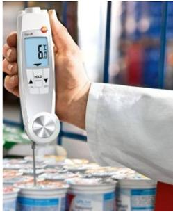
Resulta interesante el hecho de que lo que en realidad muestra un termómetro es su *propia* temperatura. Cuando un termómetro está en contacto térmico con algo cuya temperatura se desea conocer, entre los dos se intercambiara energía hasta que sus temperaturas sean iguales y se establezca el equilibrio térmico. Si conocemos la temperatura del termómetro, conoceremos la temperatura de lo que se está midiendo.
